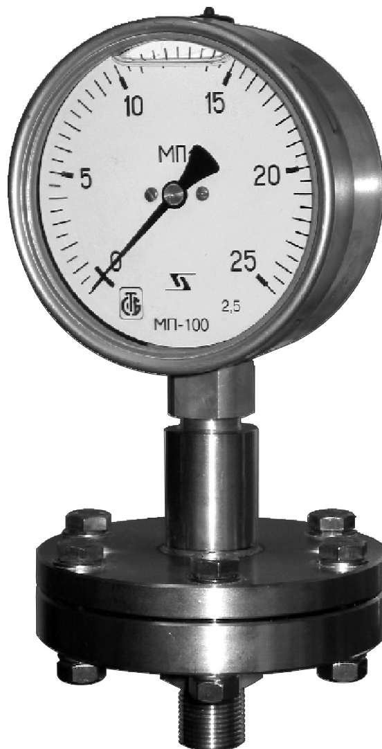
Манометр MS-100 с разделителем типа S-Comp M20×1,5 для измерения сред с повышенной вязкостью и высокой температурой
