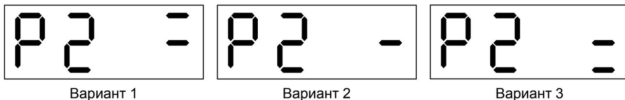
Вариант 1: реле P2 будет включено, когда измеренный параметр превысит значение  $У2+П$ , и выключено, когда измеренный параметр будет меньше значения  $У2-П$ , где  $У2$  – уставка "2",  $П$  – порог срабатывания (гистерезис, зона нечувствительности) реле.
