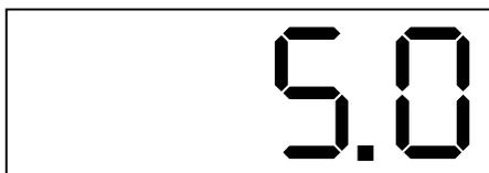
Во избежание нарушения настроек, первоначально действие кнопок изменения параметра заблокировано. Для снятия блокировки необходимо нажать кнопку ▶ и, удерживая её в этом положении, нажать и удерживать кнопку ─ до включения всех единичных индикаторов в мигающем режиме. После отпущения этих кнопок изменение данного параметра осуществляется кнопками ◀ и ▶.
