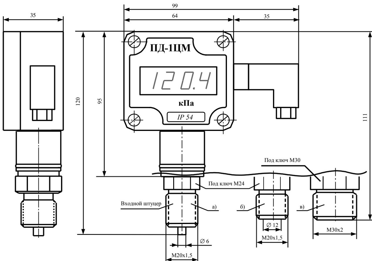
Рисунок А.1 - Габаритные и монтажные размеры ПД-1ЦМ
