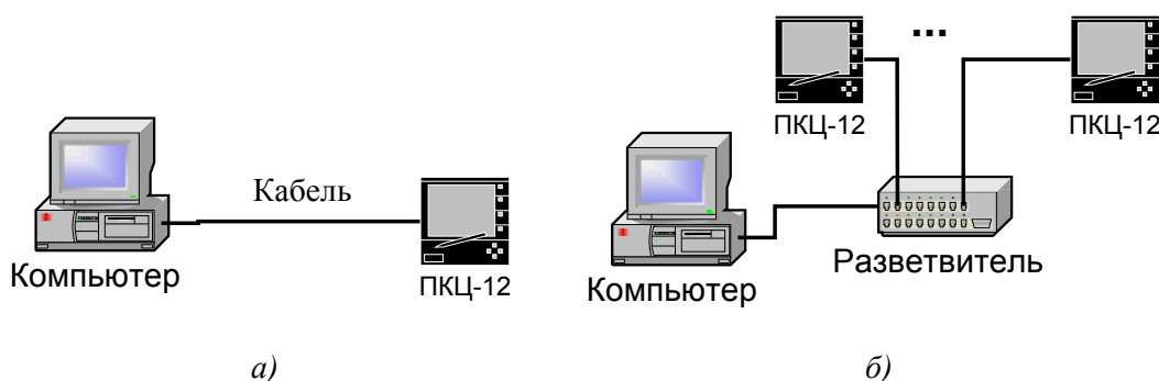
Рис. 7. Подключение ПКЦ-12К к компьютеру через RS-232C а) индивидуальное; б) групповое
