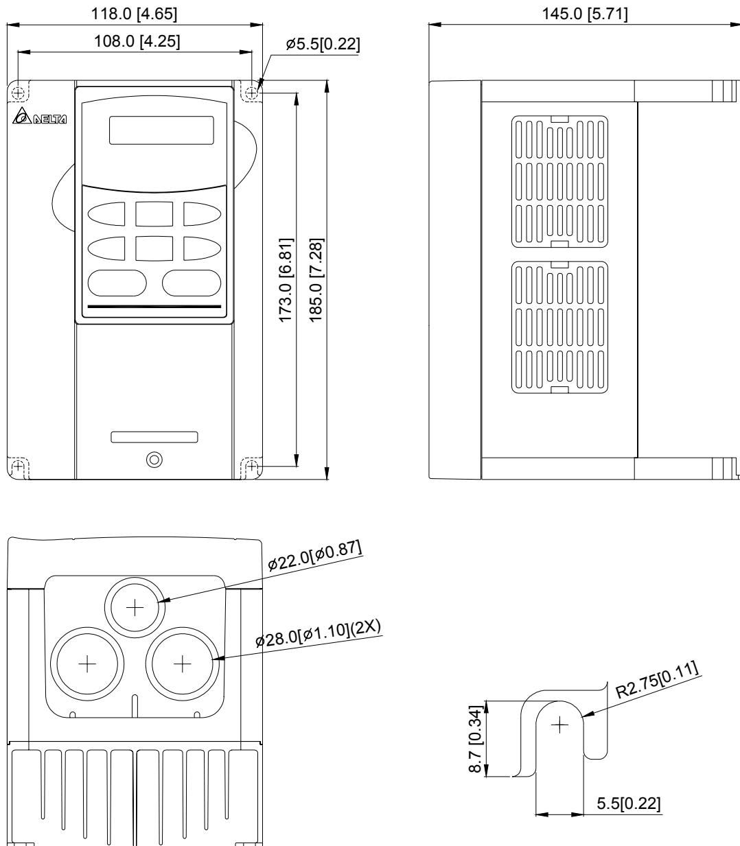
**Типоразмер А1:** VFD007B21A, VFD015B21A/23A/43A/53A
