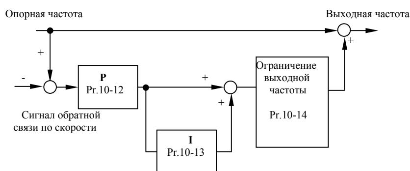
**Блок-схема управления скоростью с помощью ПИД-регулятора.**
