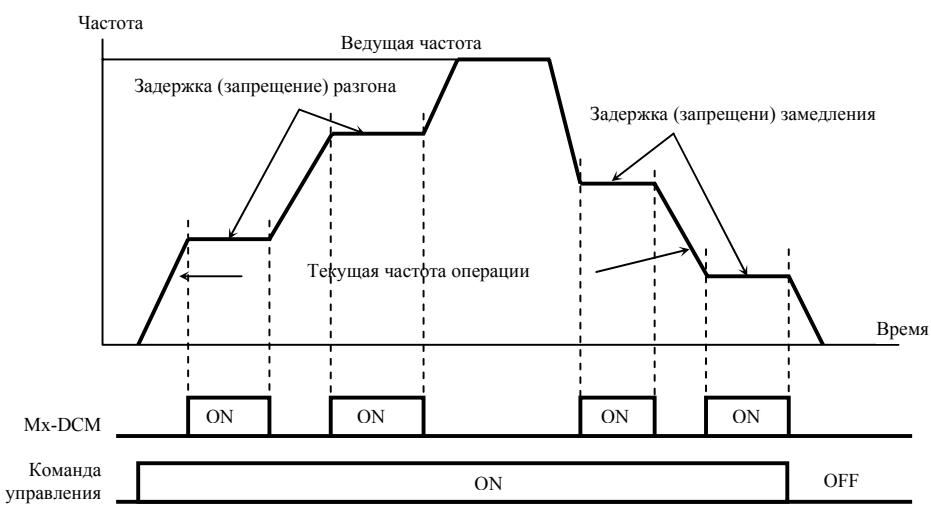
**07:** Выбор 1-ого или 2-ого времени разгона/замедления. Функция программирует входные терминалы: M1 (Пр. 4-04), M2 (Пр. 4-05), M3 (Пр. 4-06), M4 (Пр. 4-07), M5 (Пр. 4-08), M6(4-09) на функцию выбора одной из двух предустановок времени разгона/замедления (см. параметры Пр.1-09 ... Пр.1-12).
