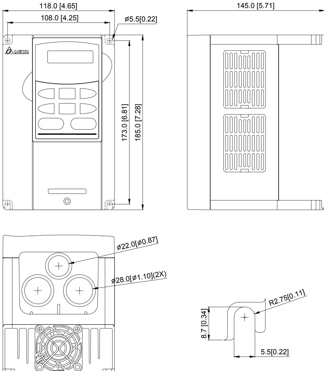
**Типоразмер В:** VFD022B21A, VFD037B23A/43A/53A
