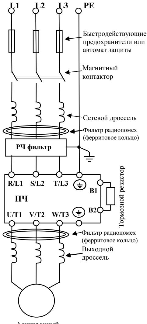
Решение о применении того или иного дополнительного оборудования пользователь принимает самостоятельно в зависимости от условий эксплуатации, режима работы и других эксплуатационных требований. Обязательным является применение быстroredействующих предохранителей, используемых для защиты входных цепей преобразователя (полупроводниковых диодов), например, фирмы BUSSMAN Limitron KTK класса СС или предохранители типа gG в соответствии с требованиями стандарта EN60269
