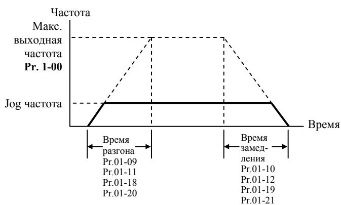
*При установке наикратчайшего времени разгона/торможения, действительное время разгона/торможения, будет зависеть от реальных механических характеристик системы, таких как момент двигателя и момент инерции.*
