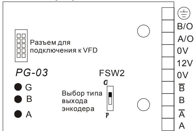
4. Типы выходов импульсного датчика (энкодера)
