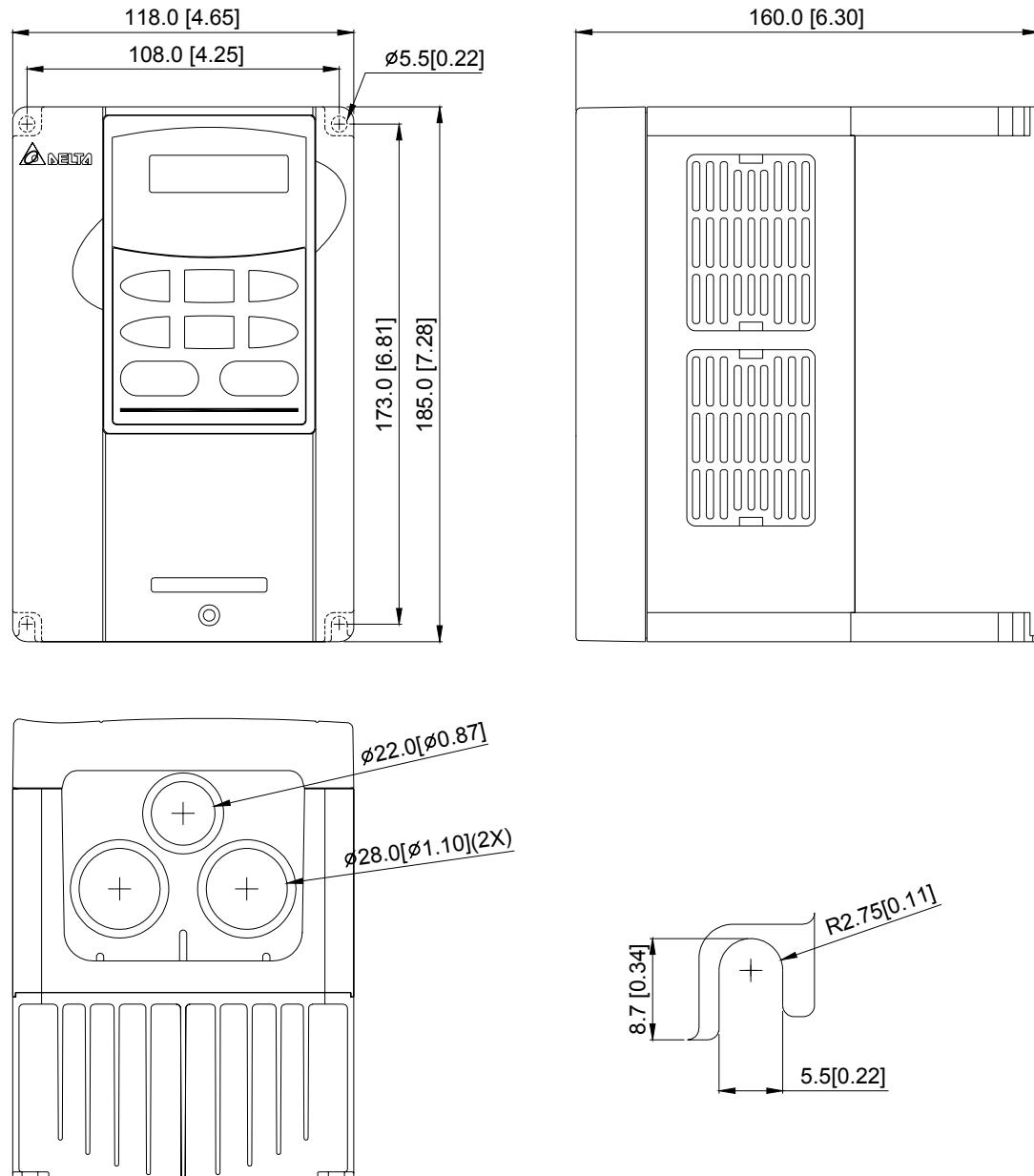
**Типоразмер А2:** VFD015B21B/23B, VFD022B23B/43B/53A
