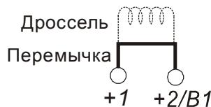
Дроссель в звене постоянного тока используется для фильтрации гармоник в потребляемом от сети токе, увеличении коэффициента мощности, защите от кратковременной асимметрии фаз источника питающего напряжения и других случаях. Перед подключением дросселя снимите перемычку с клемм [+1, +2].
