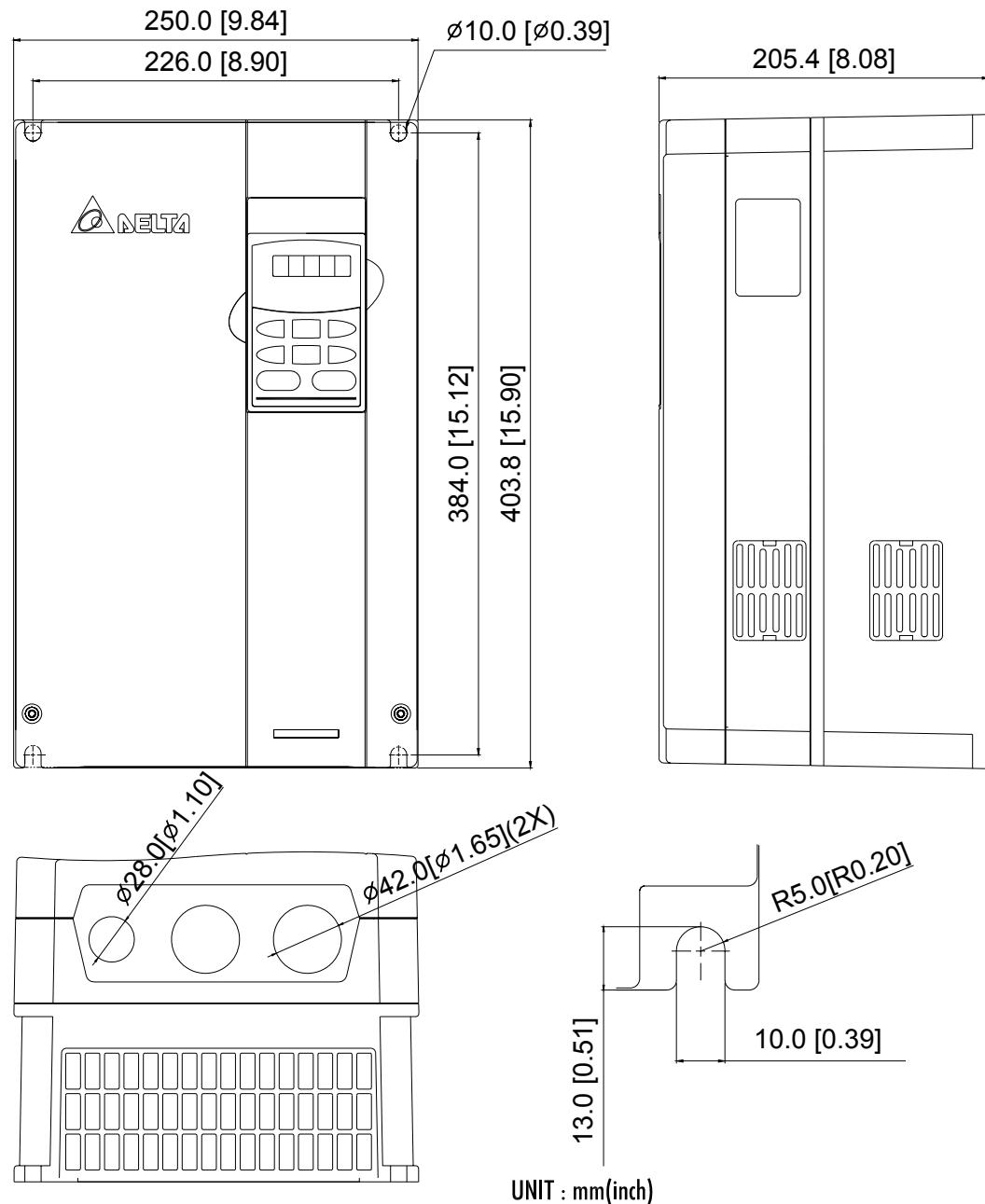
**Типоразмер Е:** VFD300B43A/53A, VFD370B43A/53A, VFD450B43A/53A
