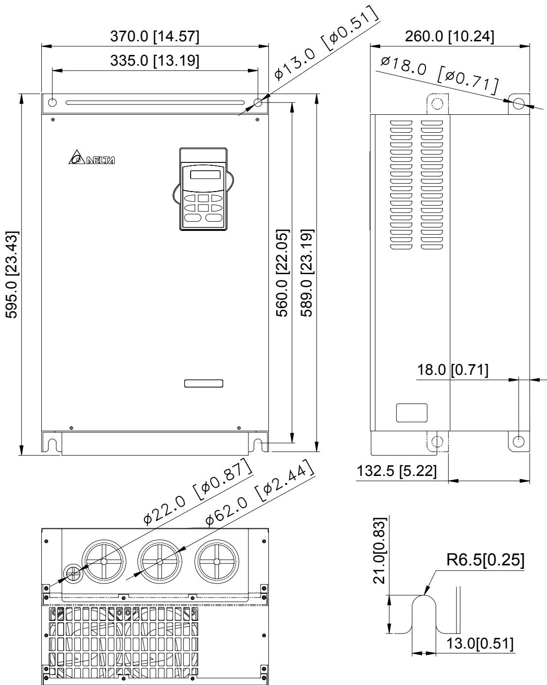
**Типоразмер F:** VFD550B43A, VFD750B43A
