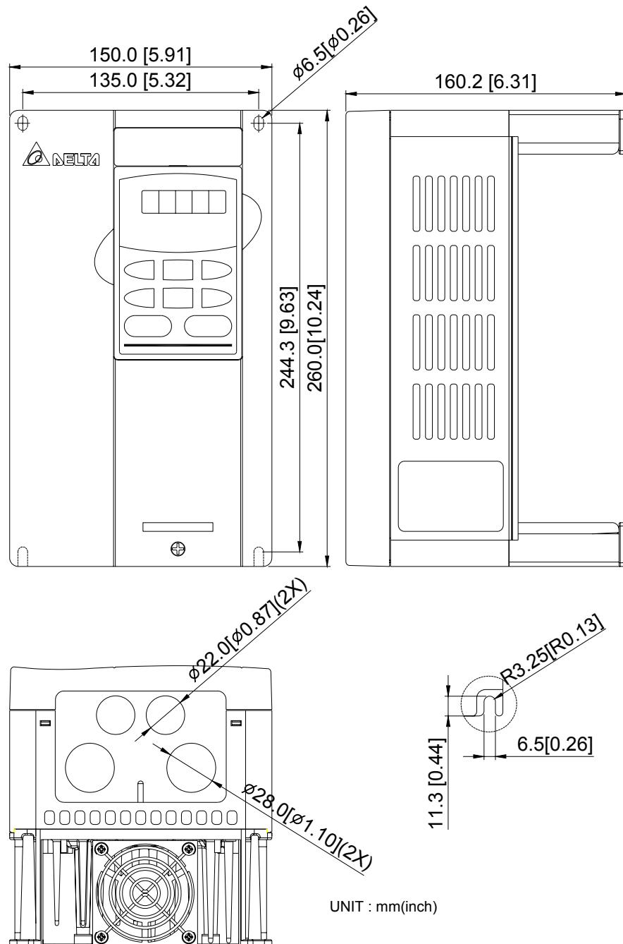
**Типоразмер С:** VFD055B23A/43A/53A, VFD075B23A/43A/53A, VFD110B23A/43A/53A
