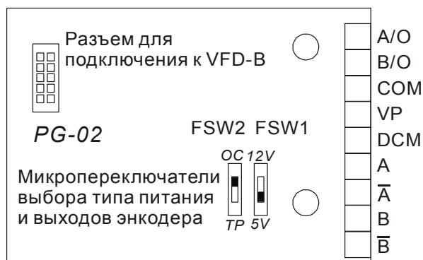
4. Типы выходов импульсного датчика (энкодера)
