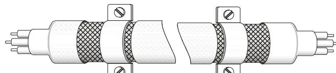
Заземление экрана на обоих концах кабеля
