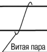
Рис. В.5. Соединительный кабель для связи панели с ПЛК или другими приборами по интерфейсу RS-485
