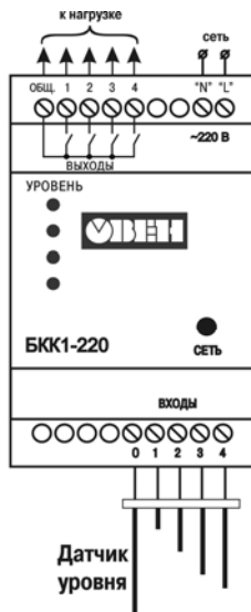
Рис. А.2. Схема подключения БКК1-220
