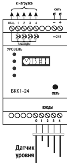
Рис. А.1. Схема подключения БКК1-24
