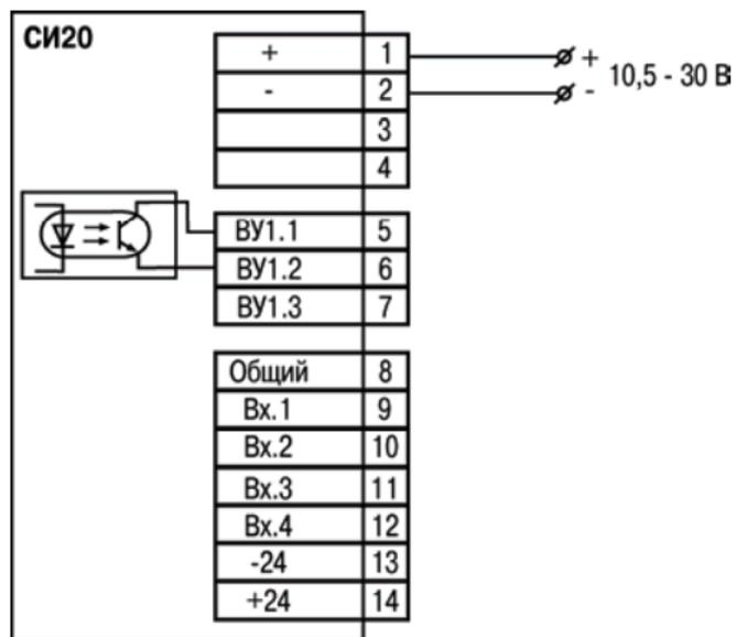
Рисунок Б.10 – Схема подключения прибора СИ20-24.Х.К
