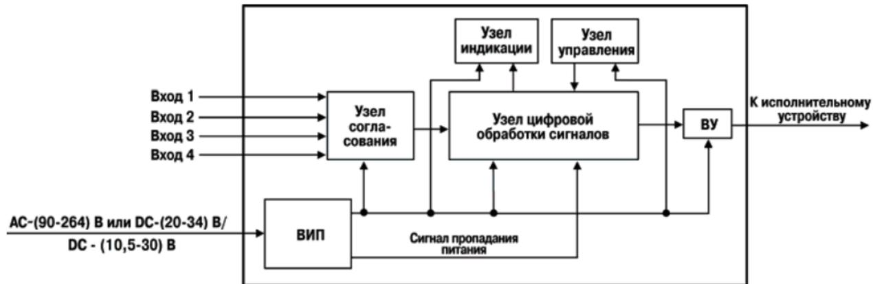
Рисунок 3.1 – Функциональная схема
