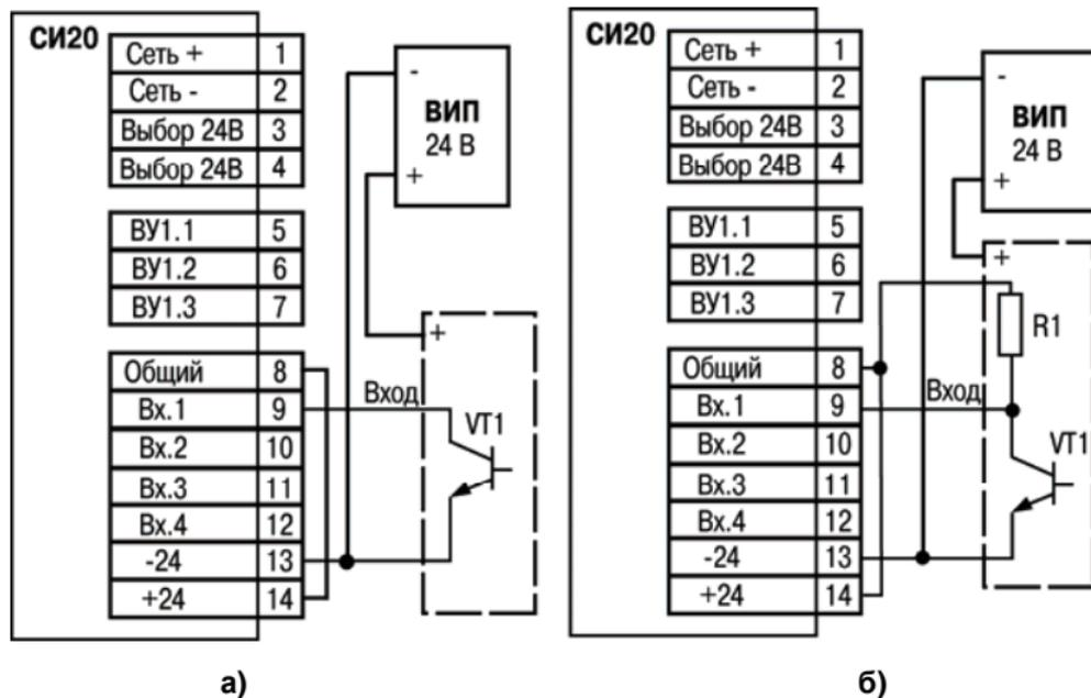
**Рисунок Б.2 – Подключение датчиков, имеющих на выходе транзистор *n-p-n* типа с открытым коллекторным входом:**
