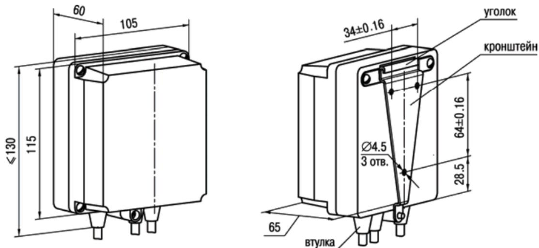
Рисунок А.1 – Прибор настенного крепления Н
