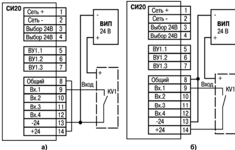
а) Рисунок Б.1 – Подключение к входу коммутационных устройств:
