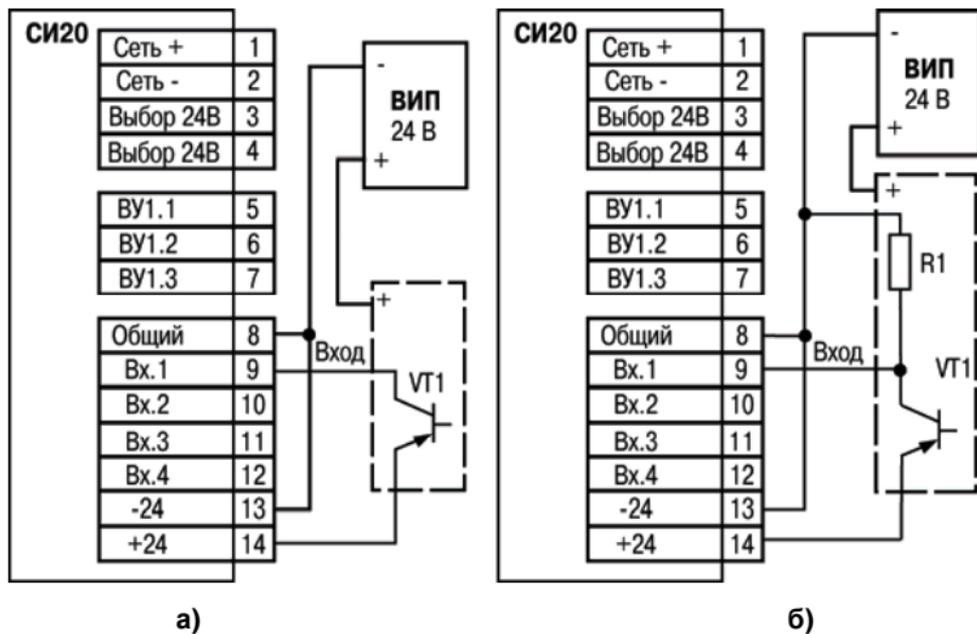
Рисунок Б.3 – Подключение к входу датчиков, имеющих на выходе транзистор *p-n-p* типа:
