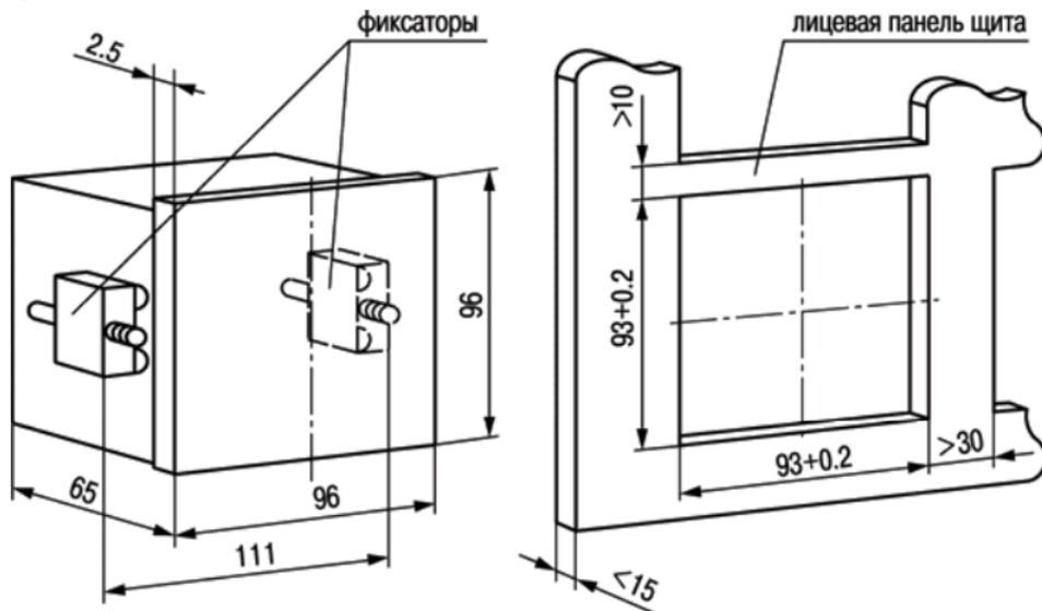
Рисунок А.2 – Прибор щитового крепления Щ1
