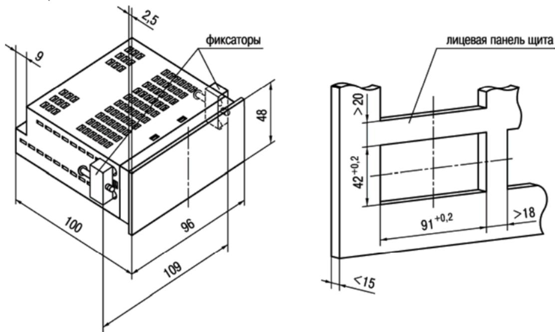
Рисунок А.3 – Прибор щитового крепления Щ2
