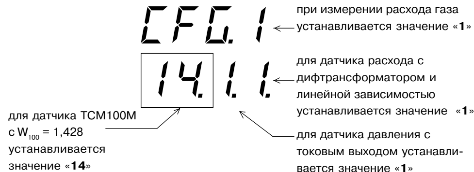
Рис. В.4 Показания верхнего и нижнего цифровых индикаторов при задании конфигурации прибора для измерения расхода газа или пара
